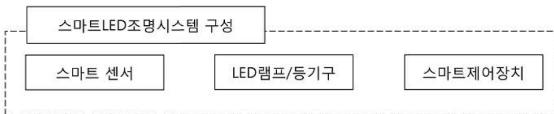
그림 1. 스마트LED조명시스템 필수 장치 구성
